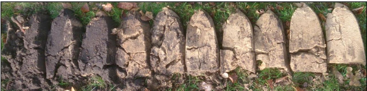
Figuur 4: boring 5 met onder de bouwvoor een geroerd pakket.
